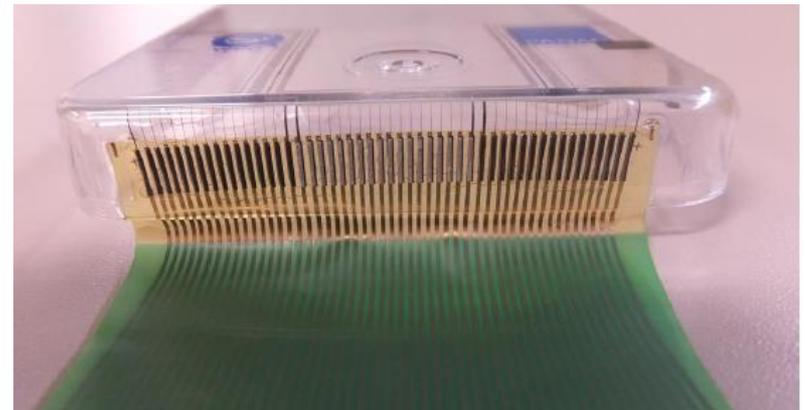
補正FPCと電磁誘導接合
